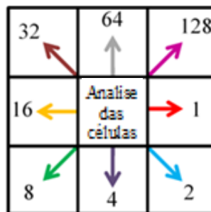
Figura 8.8 - Oito possíveis direções de fluxo no cálculo do aspecto Fonte: adaptado de ESRI (2014)
